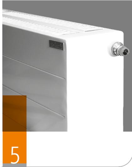
Stecken Sie den kv-Einstellschlüssel (Art.-Nr.: ZV00360001) auf den Ventileinsatz.\*\* Drehen Sie jetzt den Index des gewünschten Einstellwertes „1“ bis „8“ auf die Richtmarkierung.
